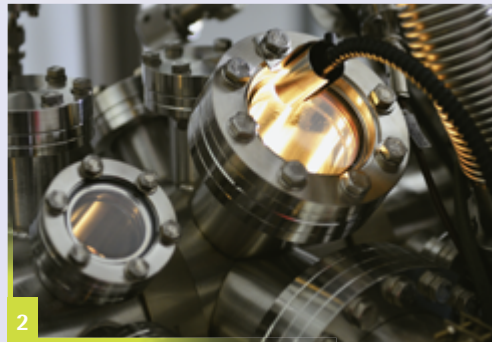
Photoelektronenspektrometer (XPS), mit dessen Hilfe am Institut für Bodenkunde die chemische Zusammensetzung von Oberflächen untersucht wird. • Quelle: Naturwissenschaftliche Fakultät der Leibniz Universität Hannover
