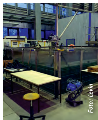
Das Wasserbecken im Unterwassertechnikum für Schweißarbeiten unter Wasser.
