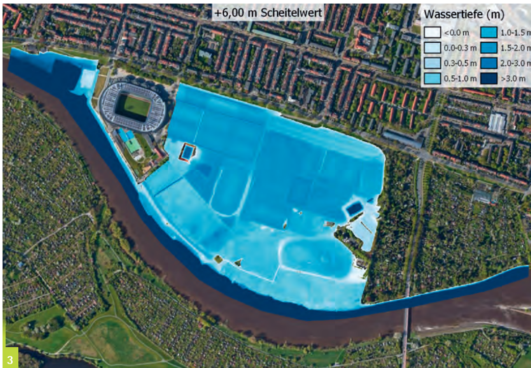
Abbildung 3 Satellitenaufnahme der Pauliner Marsch mit den mithilfe der Software HEC-RAS errechneten maximalen Wassertiefen nach einer schweren Sturmflut mit 6,00 m Höchstwasserstand. Quelle: eigene Darstellung
