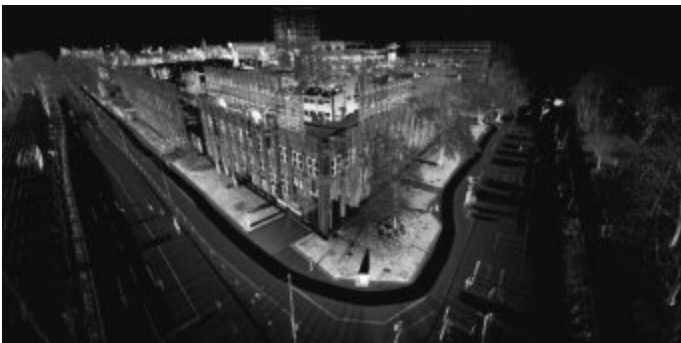
Die Nordstadt als Punktwolke – gescannt von einem mobilen 3-D-Scanner. • Abbildung: p3d systems.
