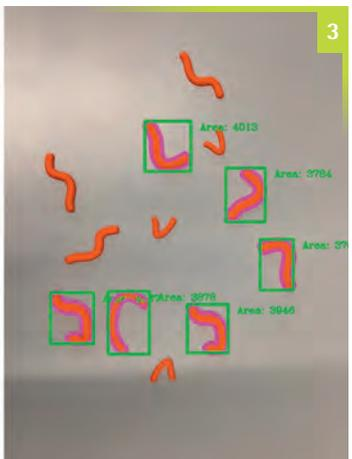
Wie KI für viele Produktionsprozesse zur Schlüsseltechnologie für die Wirtschaftlichkeitssteigerung werden kann, zeigt beispielhaft eine Extrusionsanlage aus der Kautschukverarbeitung. Hier sollen die durch zahlreiche Einflussgrößen und chargenabhängige Materialschwankungen verursachten, fehlerbedingten Ausschüsse in der manuell durchgeführten Prozesssteuerung minimiert werden.
