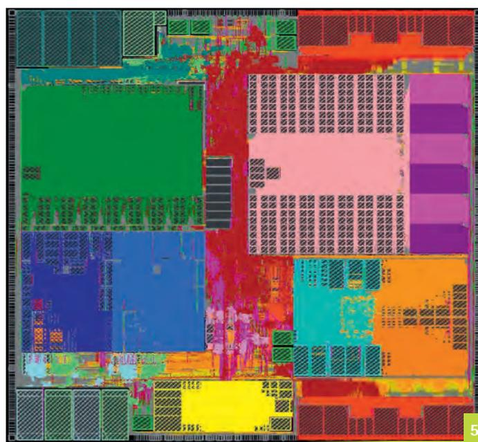
Abbildung 5 Der Siliziumchip des KI-Beschleunigers aus dem Projekt ZuSE-KI-Mobil. Zu sehen ist die Platzierung der verschiedenen Komponenten des KI-Beschleunigers auf dem produzierten Chip. Quelle: Dream Chip Technologies GmbH
