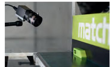
Identifikation der Bauteilorientierung in einer Zuführanlage mithilfe digitaler Bildverarbeitung und künstlicher neuronaler Netze.
